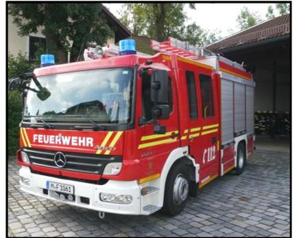
Eine Besonderheit in Trudering stellt der Schlauchwagen 2000 dar, denn ein Fahrzeug dieser Art befindet sich nur einmal in der Freiwilligen Feuerwehr München. Der Schlauchwagen, auch SW genannt, dient durch seine besondere Bauart und Ausstattung zur Verlegung von längeren Schlauchstrecken und Wasserentnahme aus offenen Gewässern. Es ist möglich bis zu 1800m Schlauch während der Fahrt zu verlegen. Zudem eignet er sich durch sein geländegängiges Fahrwerk auch besonders für unwegsames Gelände.
