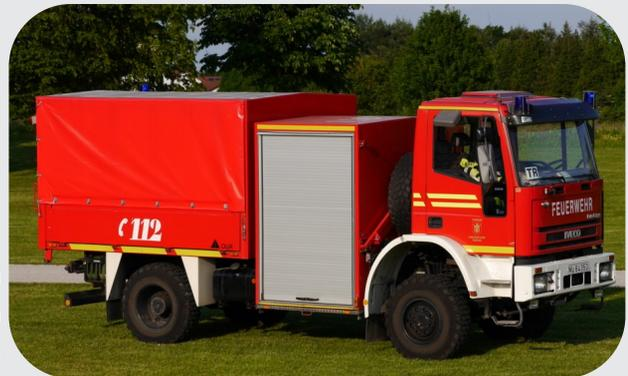
Der Schlauchwagen wird zur Verlegung von langen Schlauchstrecken in Gebieten mit einer nicht ausreichenden Löschwasserversorgung und zur Löschwasserförderung aus offenen Gewässern eingesetzt. Die Besatzung besteht aus einem Trupp (3 Feuerwehrleute). Der SW wurde vom Bund im Rahmen des Katastrophenschutzes beschafft.
