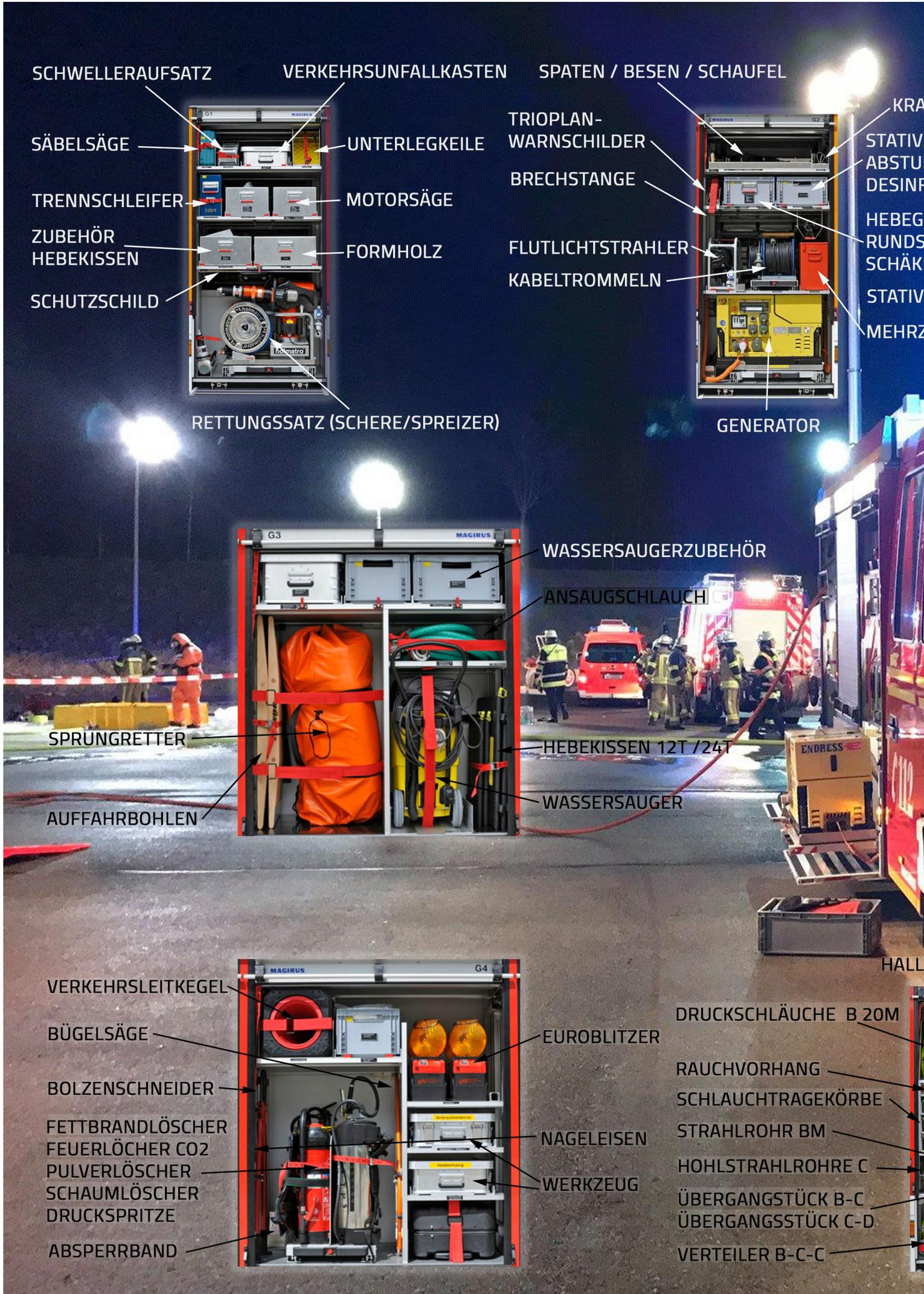
Unten abgebildet ist das HLF (HilfeleistungsLöschFahrzeug) der Abteilung Trudering. Das Fahrzeug ist nicht nur zur Brandbekämpfung, sondern auch zur technischen Hilfeleistung einsetzbar. Somit können mit diesem Fahrzeug beinahe alle im Stadtgebiet München anfallenden Einsätze bewältigt werden.
